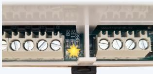
☀ El piloto ámbar se enciende cuando hay conexión con el RTU.
