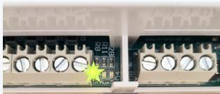
☀ El piloto verde se enciende cuando se aplica tensión a cualquiera de las cinco entradas correspondientes a otras tantas válvulas en el RTU.
