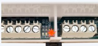
☀ El piloto rojo se encenderá cuando se transmita un paquete de datos o cuando hay una alarma.
